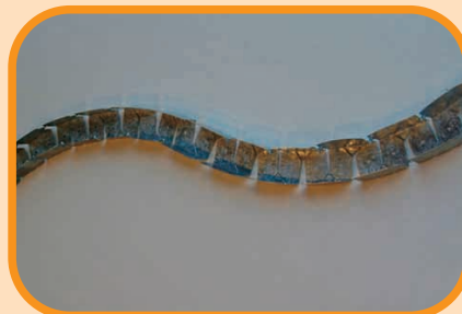
La pressione sui naselli può essere esercitata su ambedue i lati per ottenere un profilo rigido curvato ad "S".
